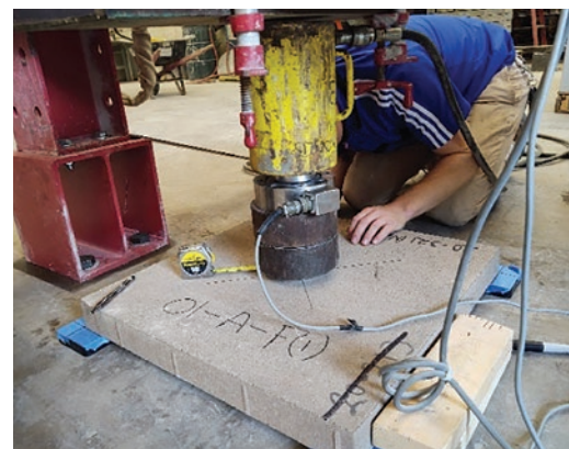
Dalle pleine grandeur, test de support de coin
